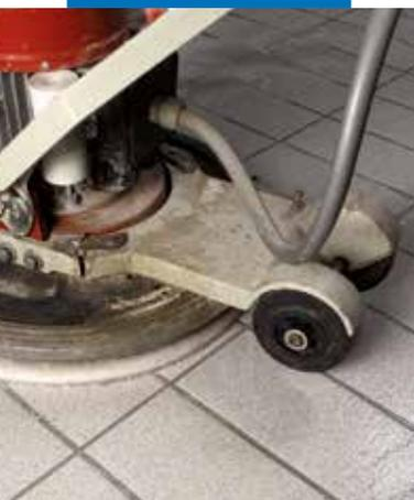
Nettoyage à l'eau en utilisant une machine à disque rotatif en feutre abrasif de type Scotch-Brite®
