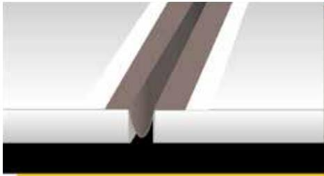
Positionnement de Mapeband PE 120 en forme d'oméga dans un joint de dilatation
